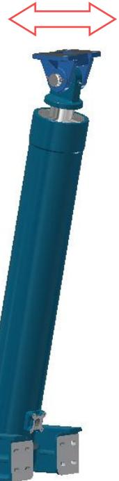
En sentido transversal el cilindro tiene un grado de libertad de  $0^\circ$
