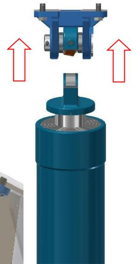
Para partir el enganche de esta forma, solo es posible con una fuerza de tracción (esta fuerza no puede existir en un basculante). Estas roturas se producen por una flexión lateral de la caja
