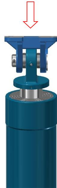
Los cilindros solo pueden soportar fuerzas de compresión. Las fuerzas de compresión no pueden arrancar la parte superior del enganche.
