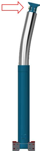
Cilindro doblado por empuje lateral. Ver: PROCESO DE VUELCO. Nunca se dobla únicamente una manga, al menos será siempre dos de ellas.
